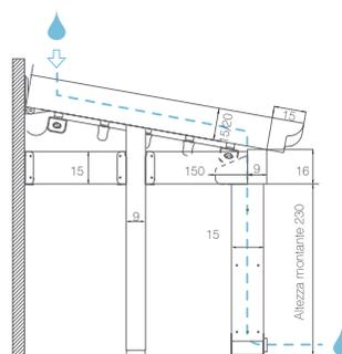
**Med Country Elite di serie** grondaia frontale con pluviale integrato nella gamba con scarico passante nel piede di fissaggio a terra
