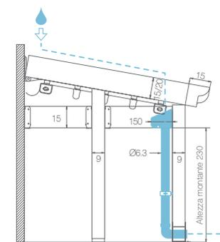
**Med Country Forma optional** grondaia frontale con pluviale esterno. Gamba con scarico passante nel piede di fissaggio a terra
