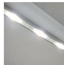
**Led Linear applicabili esternamente al frangitratta** formati da una barra preassemblata da esterno applicabile con apposite clips sotto il frangitratta. Formata da 12 led/m con potenza di 6 Watt/m è disponibile in lunghezza di cm 100/200/300. I Led Linear sono installabili anche successivamente alla posa in opera della struttura.
